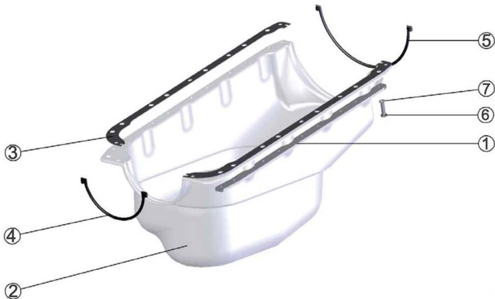
Рис. 8 Установка картера масляного
